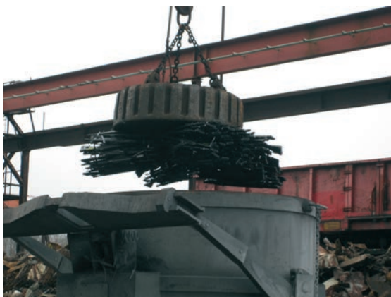
Allt skedde under noggrann kontroll. Detta smältverk hade en reningsanläggning som skulle fånga in utsläppen från vapenfettet. Påfyllningen i smältugnarna gick enligt plan, de tidigare vapnen skulle i flytande form ledas in i gjuteriet och förvandlas till bromscylindrar.
